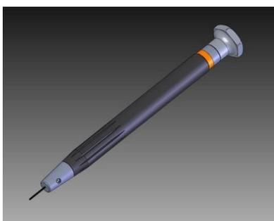
6 tournevis d'horloger de différents diamètres. Les manches sont en aluminium éloxé gris ; les têtes sont en laiton platinés ; les mèches à flancs parallèles sont en acier rapide. Chaque tournevis a une bague d'identification en aluminium éloxé dont la couleur correspond à un diamètre de mèche.
